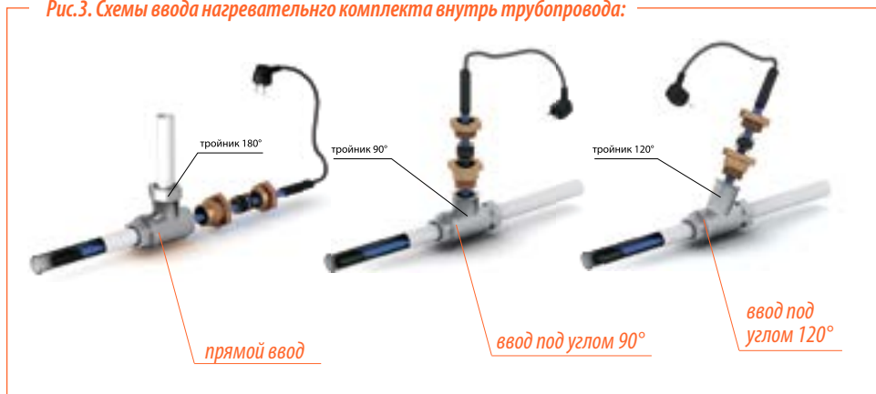
Рис.3. Схемы ввода нагревательного комплекта внутрь трубопровода:
