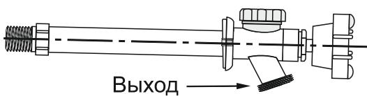
В дополнение к защите от замораживания, кран защищен от возможного поступления воды с уличной стороны через подсоединененный к нему шланг. Для этой защиты в конструкции крана предусмотрен клапан «антисифон».
